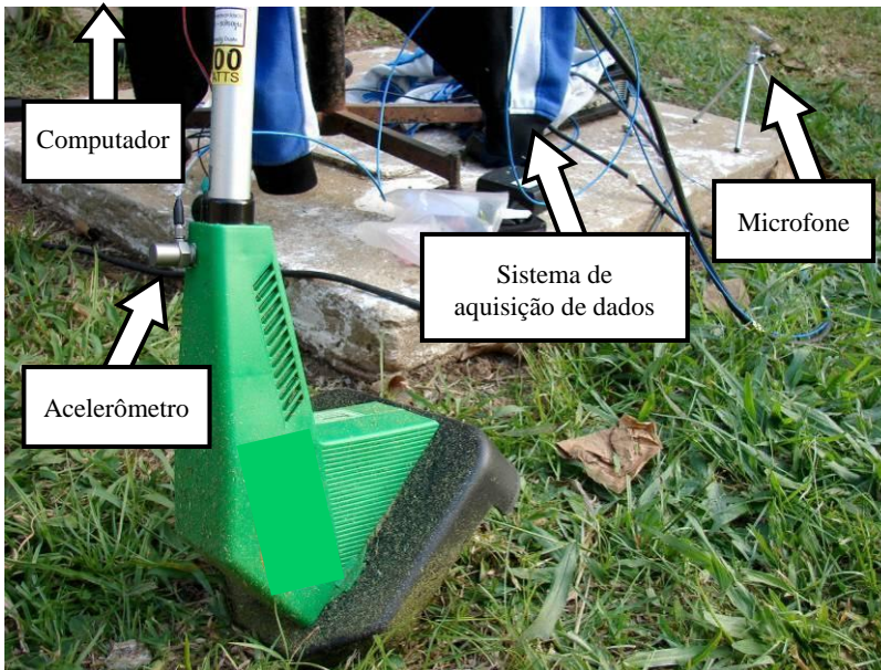
Figura E.5. Equipamentos de medição de rotação do motor.
