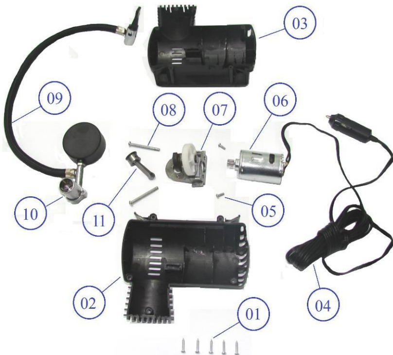
Figura F.1. Vista explodida do compressor analisado.
